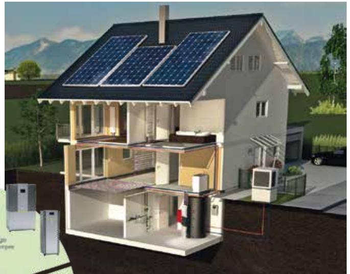
Lösungen und tauschen die Luft mit bis zu 91% Wärmerückgewinnung aus. Das bedeutet, die einströmende frische Luft ist bereits angenehm temperiert. Das hat gleich zwei Vorteile: Der Raum kühlt nicht aus und beim Heizen wird Energie gespart. Mehr Tipps für ein optimales Wohlfühlklima im Zuhause auch unter <https://blog.kermi.de/>.
